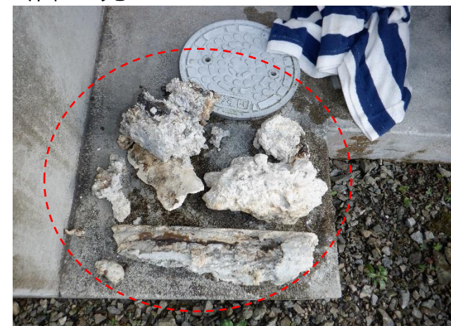
配管洗浄によって取り出された 油の塊
